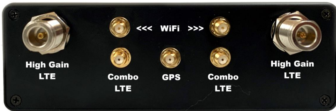
Figura 2 – Conexiones de antenas
